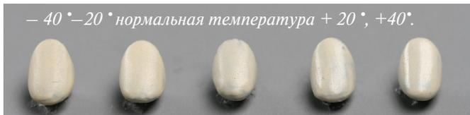
Рис. 3. Поверхность опакера, спеченного при разных температурах
