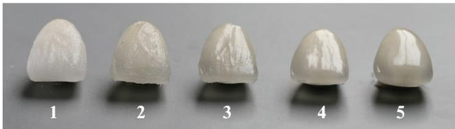
Рис. 2. Внешний вид спеченной при разных температурах керамики
